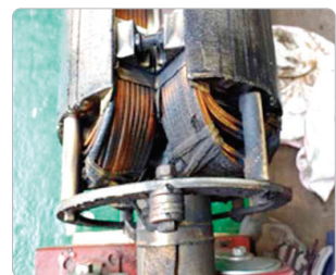
사례 3 : 진동으로 인한 볼트 풀림으로 쇼트, 먼지 방치로 인한 화재 발생
